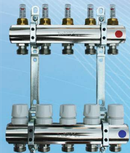
Připojovací závit DN1" vnitřní • Eurokonus DN3/4" vnější • Připojovací závit hlavice M 30 x 1,5 • Velikost skříň viz tabulka dole
