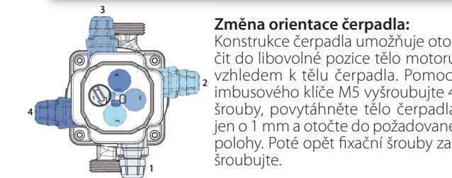
**Změna orientace čerpadla:** Konstrukce čerpadla umožňuje otocit do libovolné pozice tělo motoru vzhledem k tělu čerpadla. Pomoci imbusového klíče M5 vyšroubujte 4 šrouby, povytáhněte tělo čerpadla jen o 1 mm a otočte do požadované polohy. Poté opět fixační šrouby zasroubujte.
