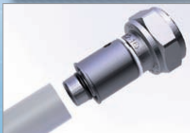
Nasunutí fitinky na trubku. O-kroužky jsou od výroby dostatečně lubrikovány.
