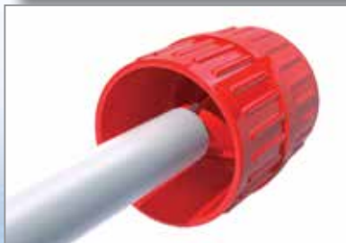
Pomocí odhrotovače odstranění otřepů na vnitřní straně trubky. TRUBKY NEKALIBRUJTE!
