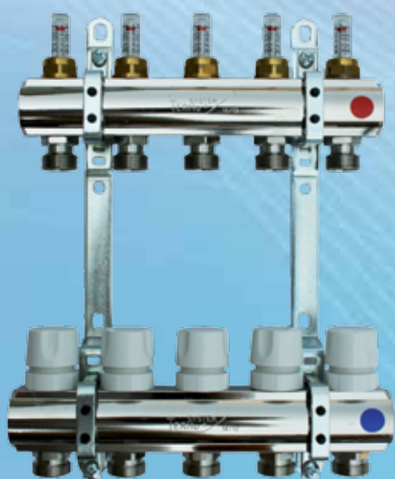
Přípojovací závit DN1" vnitřní • Eurokonus DN3/4" vnější • Přípojovací závit hlavice M 30 x 1,5 • Velikost skříň viz tabulka dole
